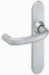
Ensemble complet plaques et béquilles solidarisées avec carré de 7 mm et vis, pour portes épaisseur standard de 40 mm et serrure entraxe à 70 mm (carré de 8 mm, autres épaisseurs et entraxes sur demande) - Fixation invisible côté extérieur par 2 vis M4 traversantes - Ressorts de soutien de béquille en option (permet la contre-levée sur les serrures multipoints) - Finitions : chrome velours, TAM et Soléco
