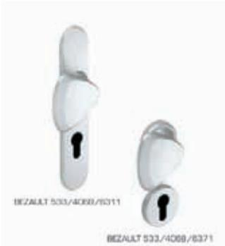
Ensemble complet plaques et béquilles solidarisées avec carré de 7 mm et vis, pour portes épaisseur standard de 40 mm et serrure entraxe à 70 mm (carré de 8 mm, autres épaisseurs et entraxes sur demande) - Poignée de tirage réversible - Fixation invisible côté extérieur par 2 vis M4 traversantes - Ressorts de soutien de béquille en option - Finitions : chrome velours, TAM et Soléco
